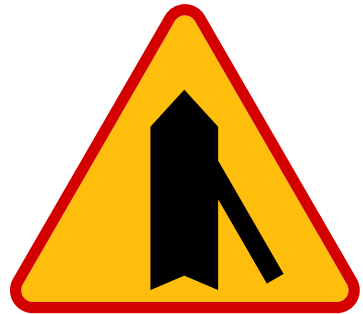
wlot drogi jednokierunkowej z prawej strony
